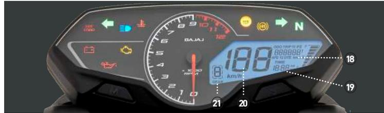
**18. Indicador de nivel de combustible bajo:** Parpadea cuando hay bajo nivel de combustible (1 barra o menos).
