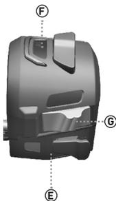
**E. Interruptor de Arranque:** el botón de arranque acciona el arranque eléctrico cuando se presiona la palanca del embrague en cualquier marcha / cambio. **Precaución:** Se recomienda arrancar el motor en punto muerto.
