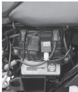
La batería se encuentra ubicada en el interior de la cubierta izquierda. Cuide del Medio Ambiente entregando la batería utilizada al **Concesionario, Taller y Centro de Servicio UMA** para su correcta disposición final.
