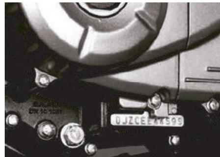
El número de Motor se ubica en la parte inferior del motor del lado izquierdo, justo debajo de la palanca de cambios.
